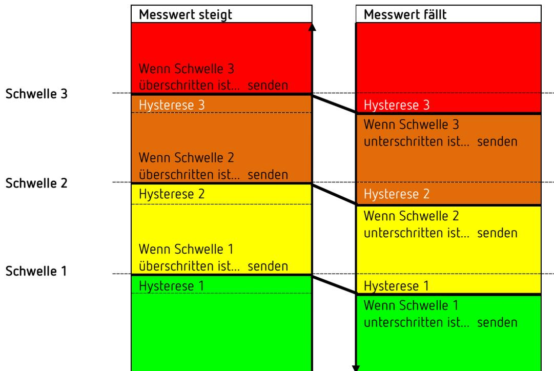
Es wird immer das Telegramm der zuletzt über- unterschrittenen Schwelle gesendet. Werden mehrere Schwellen von einem Messzyklus zum Nächsten überschritten, so werden bei ansteigendem Wert auch die Telegramme entsprechend gesendet (von Schwelle 1-3), wobei bei zyklischem Senden nur das Telegramm der zuletzt überschrittenen Schwelle zyklisch gesendet wird. Analog dazu, das Verhalten bei fallenden Werten.
