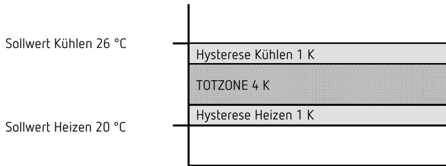
Die Totzone (4 K) wird um den Wert beider Hysterese (2K) erhöht und verschiebt den Sollwert für Kühlen auf 26 °C.
