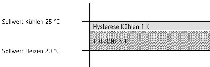
Die Totzone (4 K) wird um den Wert der Hysterese (1K) erhöht und verschiebt den Sollwert für Kühlen auf 25 °C.
