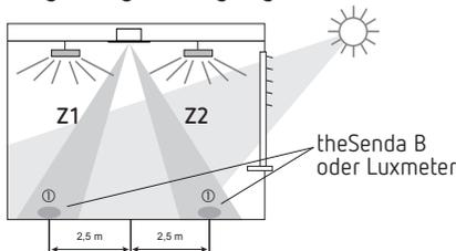
$$\text{Raum-Korrekturfaktor} = \frac{\text{Helligkeitswert an der Decke}}{\text{Helligkeitswert am Boden}}$$
