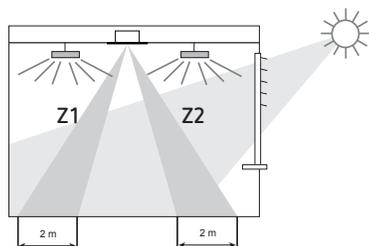
Jede Lichtmesszone bildet am Boden ein Rechteck von etwa 2 x 4 m ab. Je nach Betriebsart und nach ausgewählter Erfassungszone sind die Lichtmessungen wie folgt zugeordnet:
