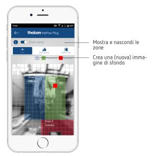
Il movimento/la presenza rilevati dal rivelatore di presenza vengono visualizzati in verde (movimento) e in rosso (presenza).
