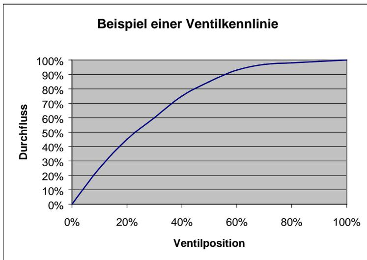
Ideal für die Regelung wäre eine lineare Kennlinie wie sie in Diagramm 2 abgebildet ist. Mit Hilfe der Eingabe einer eigenen Kennlinie kann eine nichtlineare Kennlinie linearisiert werden.
