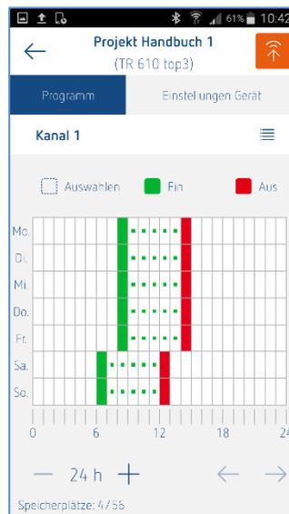
Bei der grafischen Programmierung können die Schaltzeiten **pro Kanal** per Touch in ein Gitternetz eingefügt werden. Die Auflösung (Zeiteinheit pro Gitterelement) kann über die Zoomfunktion „- 24 h +“ skaliert werden (1 Stunde, 30 Minuten, 15 Minuten). Ist die Zeiteinheit kleiner als 1 Stunde (30 Minuten, 15 Minuten) kann der Programmierbereich mit den Pfeilen nach links bzw. rechts gescrollt werden.
