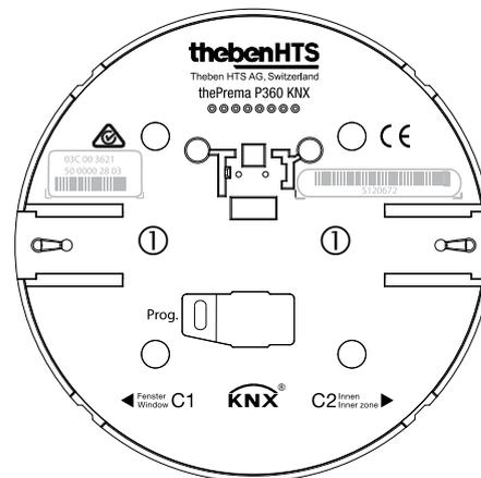
Mechanische Sicherheitsverriegelung ①
