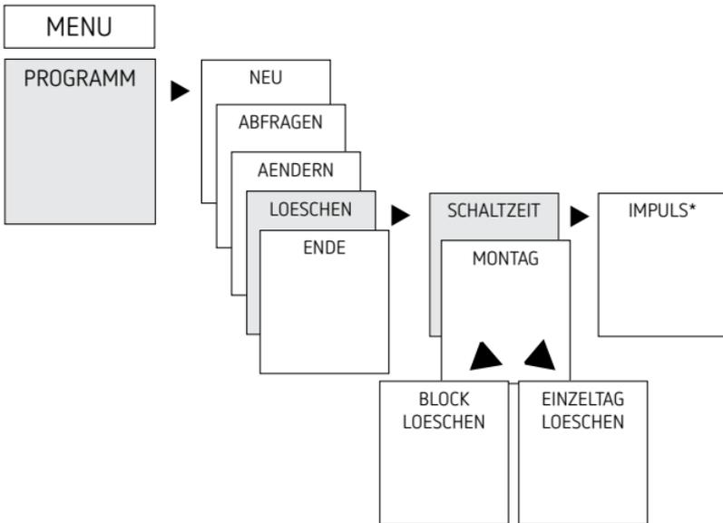
① Sie können entweder einen Block löschen d. h. eine Schaltzeit, die auf mehrere Tage (z. B. Mo-Fr) kopiert ist, oder eine einzelne Schaltzeit
