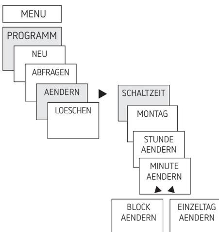
① Sie können entweder einen Block ändern, d. h. eine Schaltzeit, die auf mehrere Tage (z. B. Mo-Fr) kopiert ist, oder eine einzelne Schaltzeit
