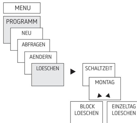
① Sie können entweder einen Block löschen d. h. eine Schaltzeit, die auf mehrere Tage (z. B. Mo-Fr) kopiert ist, oder eine einzelne Schaltzeit
