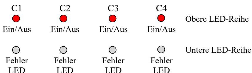
Bei Übertemperatur oder Kurzschluss der Last wird auf 0% heruntergedimmt und die untere LED blinkt.
