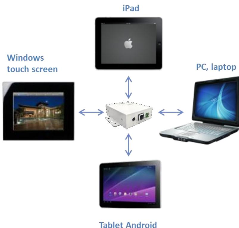
L'illustration présente une installation standard du système theServa dans un dispositif KNX. Le mini-serveur theServa communique avec KNX par le biais d'une interface KNX bipolaire. La communication avec d'autres appareils, comme par ex. un émetteur IR, est assurée via Ethernet.
