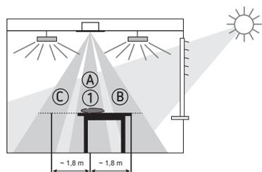
Ogni zona di misurazione della luce crea, ad altezza tavolo, un rettangolo di circa 2,0 x 3,5 m. A seconda del modo di funzionamento le misurazioni della luce sono assegnate come segue:
